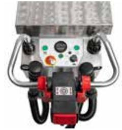
Der Lenkgriff ist aus Edelstahl gefertigt und mit einer Handgelenkerdung für den Maschinenbediener ausgestattet
