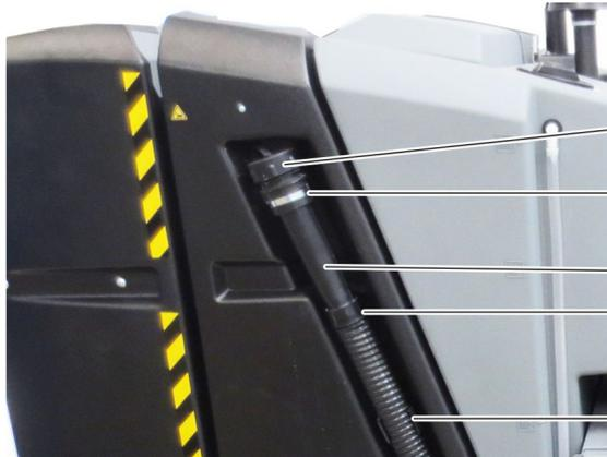
**Der Ablassschlauch vom Schmutzwassertank befindet sich auf der rechten Seite des Geräts.**
