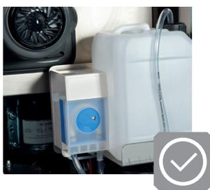
GWS Chemplus optional erhältlich. An der Dosierpumpe kann das Mischungsverhältnis im 10er Raster von 1:5000 bis 1:50 (0,2-2 %) eingestellt werden.
