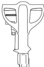
Die Bürstentaste drücken, hierdurch schalten sich die Absaugung und der Wasserzulauf ein.
