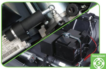
Wartungsfreie Batterien mit AGM-Technik. Mit dem System SLS ist die Energieaufnahme minimal, dank der ständigen Anpassung an jede Bodenart und der automatischen Regelung des Besendruckes.
