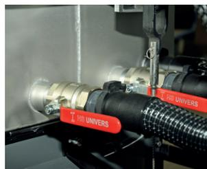
Der Absperrhahn am Ablassschlauch ist serienmäßig
